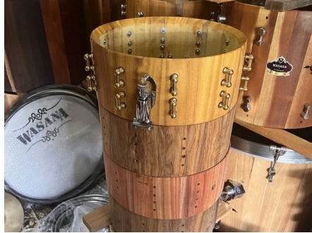
รูปที่ 2 ตัวถังกลองสนแอร์ที่ผลิตขึ้นมาจากพรรณไม้ ในประเทศไทยทั้ง 3 ชนิด ที่มา : ผู้วิจัย
